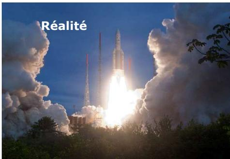
**Doc. 4 : propulsion par réaction : les gaz sont propulsés vers le bas et la fusée vers le haut.**
